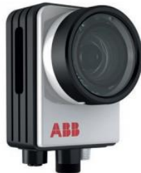
Abbildung 31: Kamera Cognex Typ DSQC1021 [29].
