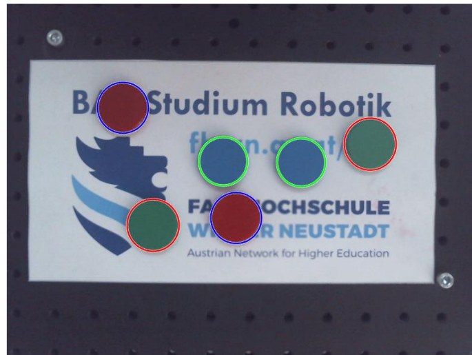
Abbildung 46: Nach Farben erkannte Scheiben.
