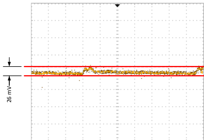
Abb. 8-2: Welligkeit 3,3V Ausgang
